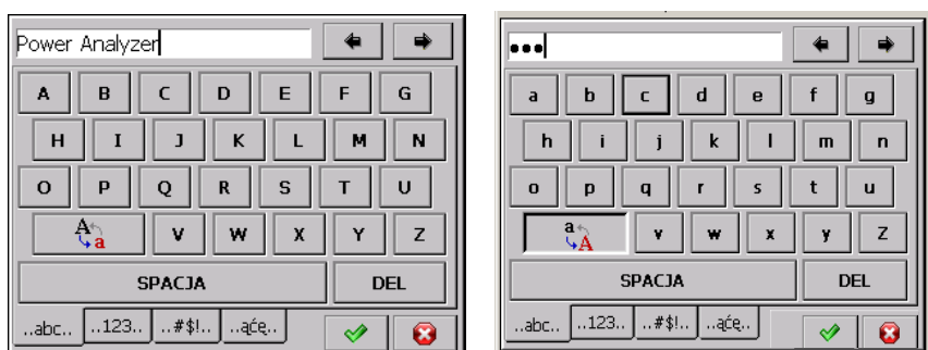
Wprowadzania ciągu znaków (małe i duże litery, liczby i znaki specjalne, hasło)
