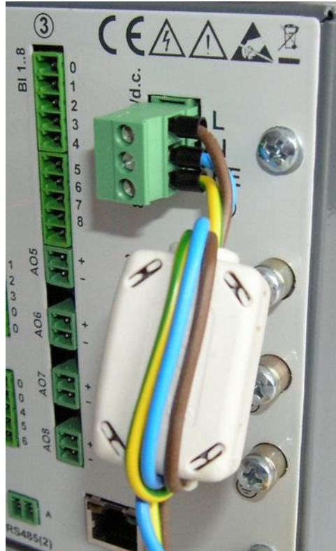
Rys. 4.4. Podłączenie filtra sieciowego.
